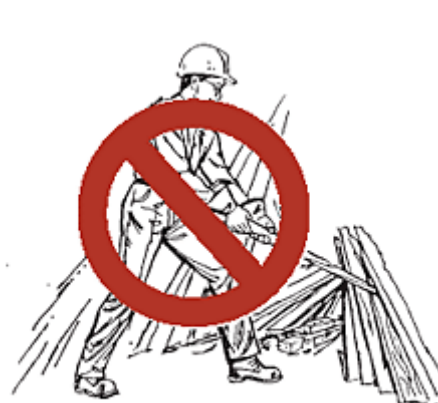
请勿拖曳废墟中的凸出物体
